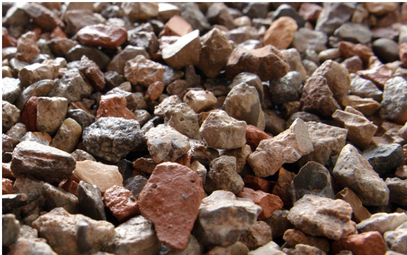
Rezyklierter Gesteinszuschlag ist hier an roten Ziegelteilen zu erkennen.
