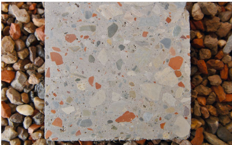
R-Beton im Querschnitt – bis auf den roten Ziegelzuschlag ist R- Beton optisch nicht von herkömmlichem Beton zu unterscheiden
