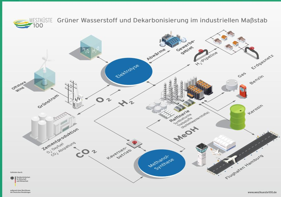
Das Ziel des Reallabors WESTKÜSTE100 ist der Aufbau sowie die erfolgreiche Umsetzung einer regionalen Wasserstoffwirtschaft im industriellen Maßstab. Dabei soll mittels Windenergie und auf Basis eines 30-Megawatt-Elektrolyseurs grüner Wasserstoff erzeugt und durch die Verzahnung verschiedener Sektoren für industrielle Zwecke genutzt werden.
