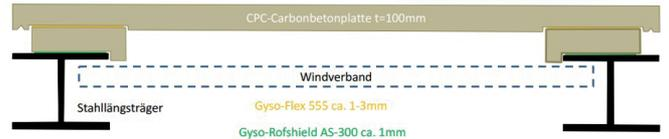
Brückenquerschnitt mit CPC-Carbonbetonplatte und eingefrästen Wassermassen respektive Aufgervertiefungen. Durch die verschachtelte Bauweise können sich die Balken und die Platte auch ohne Verschraubungen in die Stahlträger gegenüber der Haupttragkonstruktion nicht mehr verschieben. Das genügende Gewicht verhindert das Abheben der Platte auch bei Erdbeben oder starken Sturmwinden.
