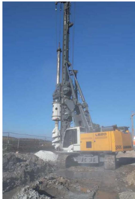
Abb. 8.8.9 (rechts o.) Bohrfahl direkt nach Herstellung
