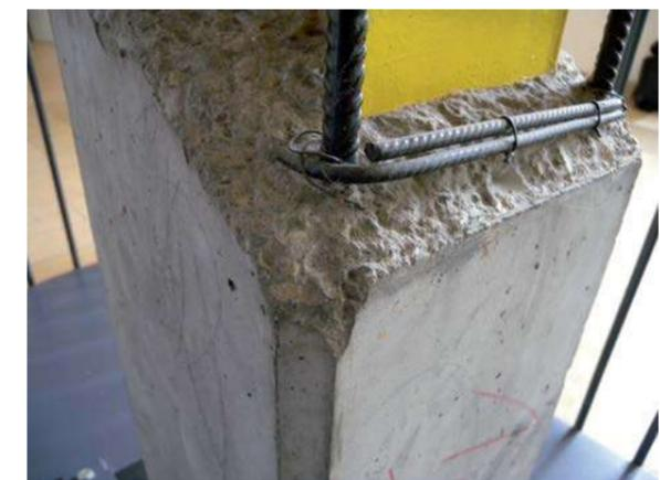
Abb. 3.4.5 Schnitt durch Betonstütze mit Sicht auf Bewehrungseinlage
