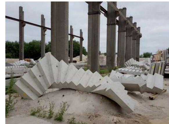
Durch die Fertigung im Betonfertigteilwerk ist es möglich, größtenteils witterungsunabhängig Bauteile in gleichmäßig hoher Qualität zu produzieren. Kurze Transportwege innerhalb eines Werkes sowie die Fertigung in Serie begünstigen einen schnellen und wirtschaftlichen Herstellprozess.
