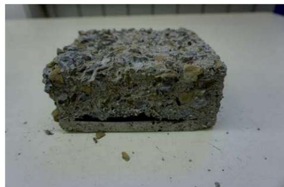
Abb. 3.2.7 (rechts) Probekörper nach 28 FTSW mit geringen Abwitterungen
