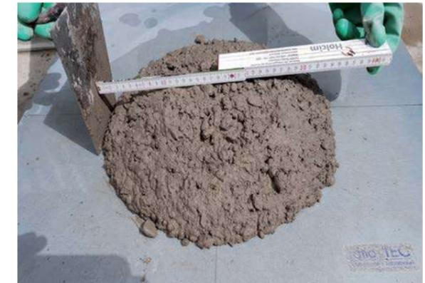
Abb. 5.3.4 Stark angesteifter Beton, infolge hoher Außentemperaturen
