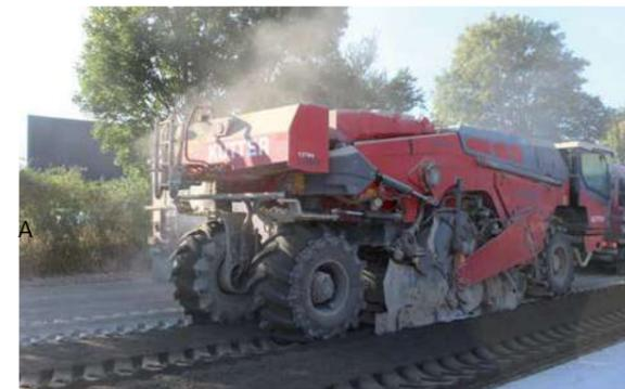
Abb. 8.18.2 Maschine beim Ausstreuen von Bodenverfestigungsmaterial
