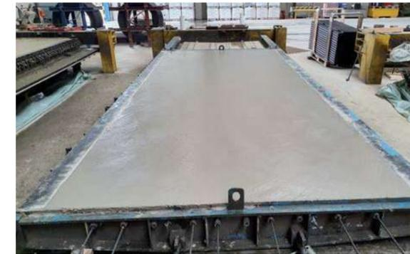
Abb. 7.16.2 Element hergestellt aus Geopolymerbeton
