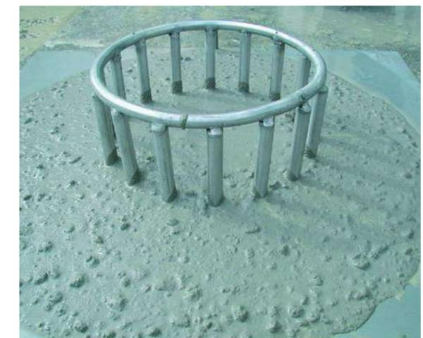
Abb. 3.8.8 (rechts) Setzmaß - Selbstverdichtender Beton, mit Blockierring
