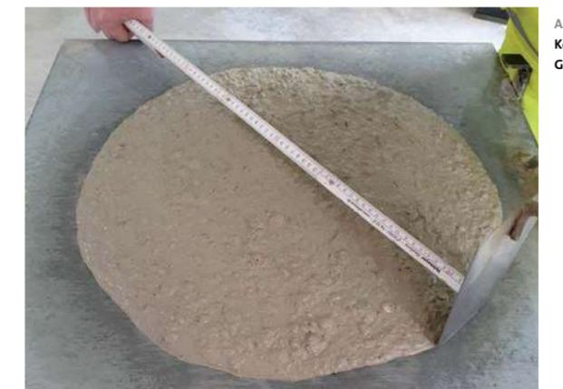
Abb. 7.16.3 Konsistenzmessung Geopolymerbeton
