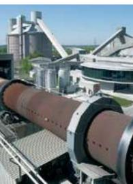
Abb. 1.1.4 Drehrohren, das Herzstück eines Zementwerks
