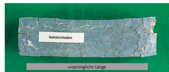
Abb. 10.6.1 Durch Sulfatangriff geschädigtes Zementmörtelprisma, Volumenvergrößerung (Treiben)
