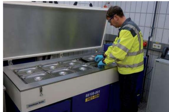
Abb. 3.2.5 (rechts) Boxen zur Lagerung der Prüfkörper in Prüfflüssigkeit
