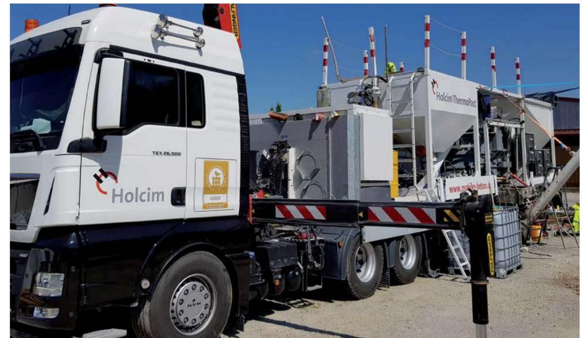
Abb. 7.14.4 Mobile Mischanlage für Infraleichtbetonanwendungen
