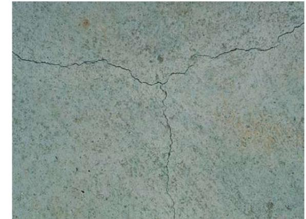
Abb. 10.3.10 Risse auf Grund von Trocknungsschwinden
