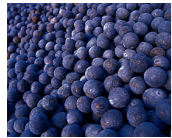
... und wird mit Hilfe von Mahlkugeln aufgemahlen
