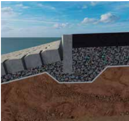
Anschluss mit Tiefbord an Treibselräumweg
