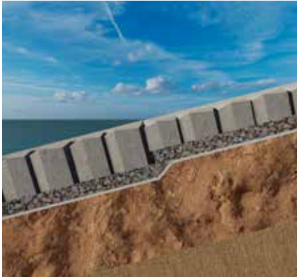
Aufbau der Filterschicht mit darunterliegendem Geotextilvlies
