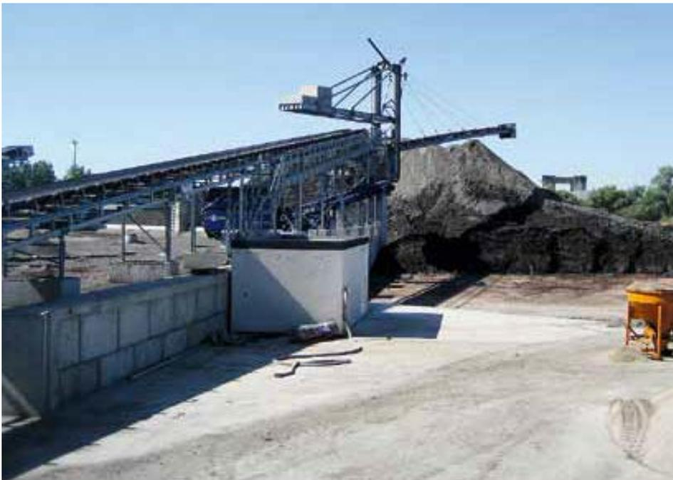
AUS BAGGERSCHLAMM ENTSTEHT EIN GUT HANDHABBARES MATERIAL FÜR DEN DEPONIEBAU
