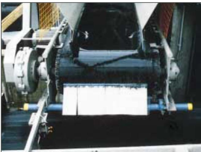
Eine Vielzahl ähnlicher und anderer Reinigungseinrichtungen – starre oder rotierende Abstreifer, klopfende oder vibrierende Geräte, Spüleinrichtungen – werden angeboten, so dass für fast alle Einsatzbereiche geeignete Geräte zur Verfügung stehen. Zusätzlich können Trommeln und Rollen mit selbstreinigenden Belägen ausgerüstet werden.
