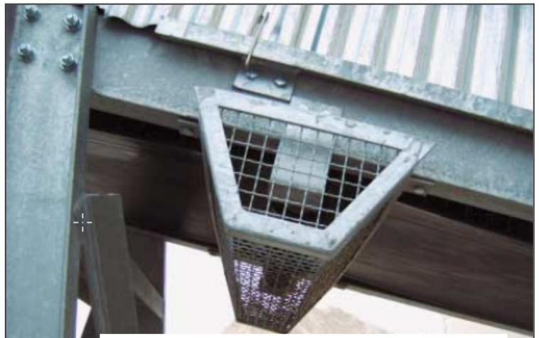
Bild 15 Untergurtrollenschutz mit vollumschliessender Schutzeinrichtung
