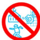
Arbeite nicht an ungeschützten Maschinen, nicht unter schwebenden Lasten oder in abgesperrten Bereichen
