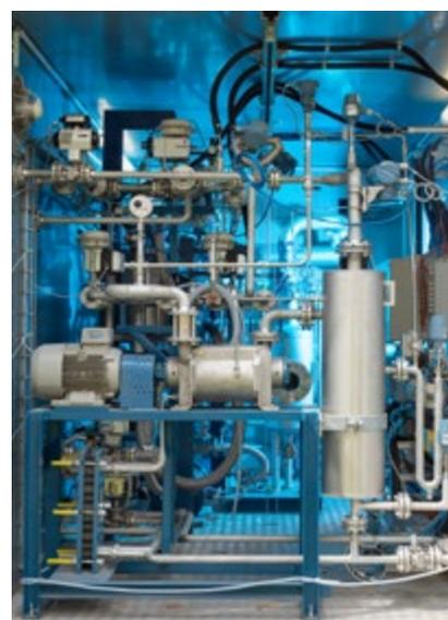
CO<sub>2</sub>-Abscheide-Testanlage im Zementwerk Höver
