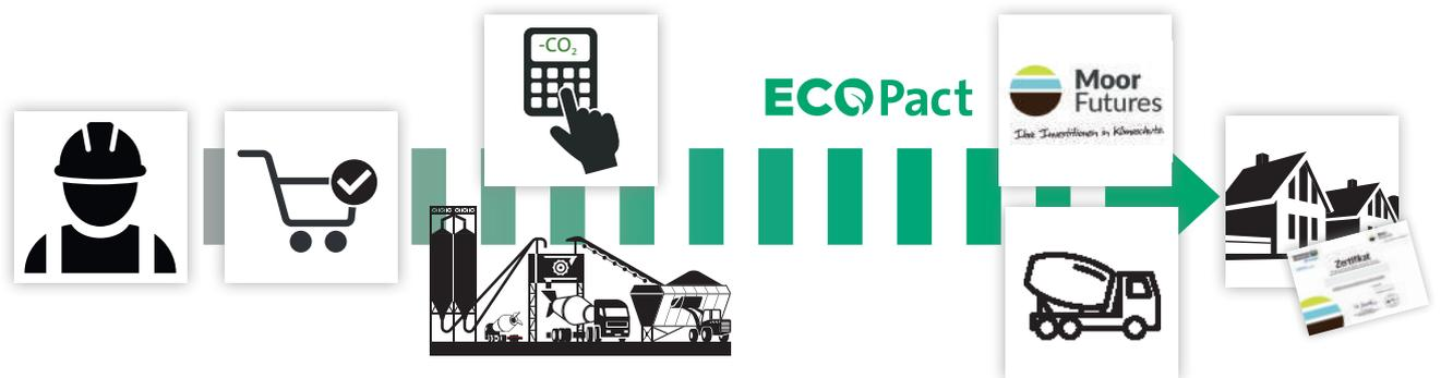
Holcim ECOPact Zero ist ein nachhaltiges Produkt der Holcim Deutschland Gruppe. Durch die Verwendung CO<sub>2</sub>-reduzierter Zemente, einer optimalen Betonzusammensetzung sowie die Kompensation der prozessbedingten CO<sub>2</sub>-Emissionen innerhalb Deutschlands ist Holcim ECOPact Zero ein klimaneutraler Beton, der den Normen DIN EN 206 und DIN 1045-2 entspricht.
