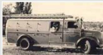
Fahrzeugart: Löschgruppenfahrzeug LF 8
