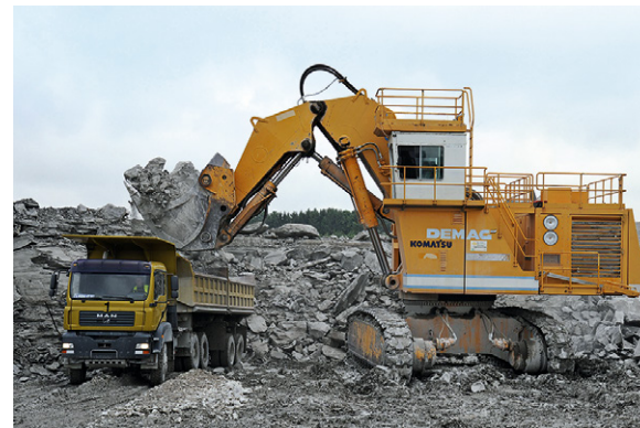
Im Steinbruch befüllen Hydraulikbagger Schwerlastkraftwagen mit Kalkmergel
