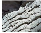
Der stückige Filterkuchen hat eine Restfeuchte von 20 Prozent
