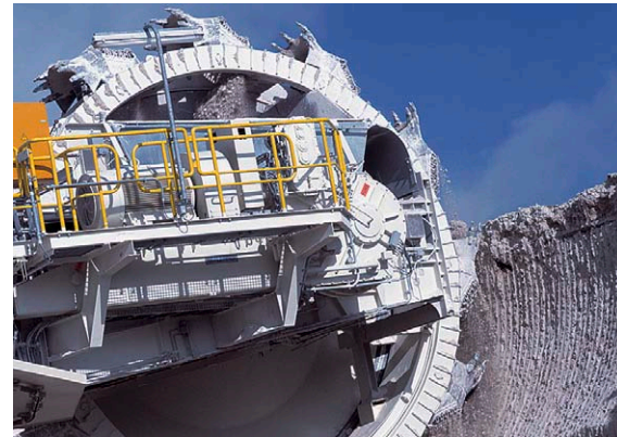
7,20 Meter misst das Schaufelrad eines in Lägerdorf eingesetzten Baggers im Durchmesser
