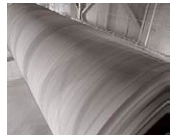
In der Zementmühle entsteht aus Klinker feiner Zement
