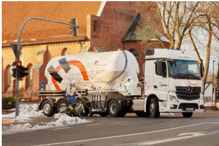
Akustische und optische Warnung – Der intelligente Abbiege-Assistent von Mercedes-Benz erkennt unter anderem Hindernisse auf der rechten Seite.
