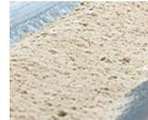
**Der entwässerte Hüttensand hat eine Restfeuchte von maximal 10 Prozent. Das Filtratwasser fließt wieder zurück in den Produktionsprozess**
