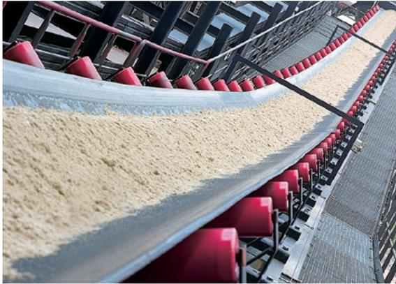
**Gurtbandförderer transportieren den entwässerten Hüttensand zur Lkw-Beladestation**
