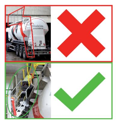
Fest installierte Aufstiegsplattformen erhöhen Ihre Sicherheit erheblich, da sie einen integrierten und sicheren Aufstieg auf das Silofahrzeug ermöglichen.
