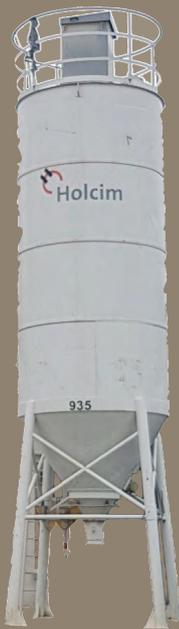
Freifall-Stahlblechsilos mit Einblasrohr für Silofahrzeuge, Filter, Füllmelder sowie elektrischer und pneumatischer Auflockerung.
