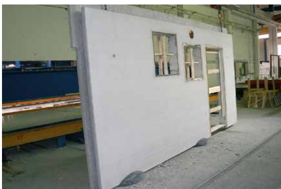
Abb. 9.3 Abheben des Elements nach der Trockenkammer
