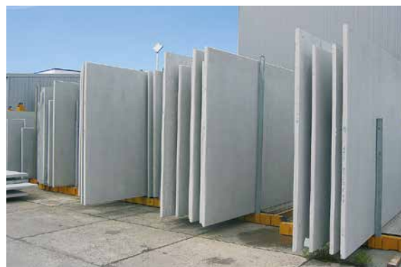
Abb. 3.4 Hohl- bzw. Doppelwände, im Wendeverfahren hergestellt
