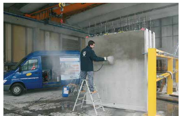
Abb. 6.21 Auftragen einer pigmentierten Lasur
