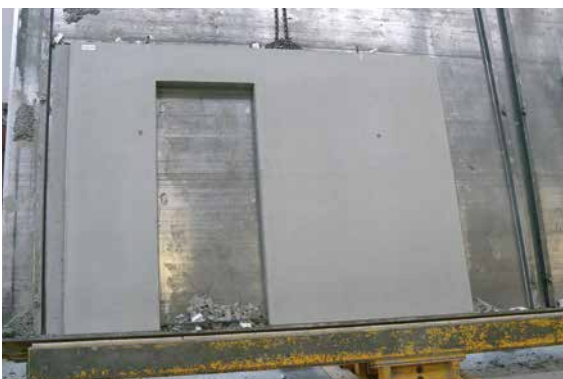
Abb. 3.3 Vollwand, hergestellt im Wendeverfahren
