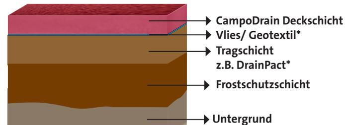
\* Das Vlies/ Geotextil kann bei Verwendung einer Tragschicht aus DrainPact entfallen.
