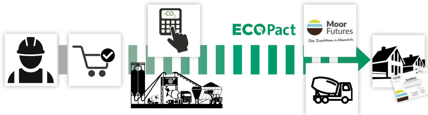
Holcim ECOPact Zero ist ein nachhaltiges Produkt der Holcim Deutschland Gruppe. Durch die Verwendung CO<sub>2</sub>-reduzierter Zemente, einer optimalen Betonzusammensetzung sowie die Kompensation der prozessbedingten CO<sub>2</sub>-Emissionen innerhalb Deutschlands ist Holcim ECOPact Zero ein klimaneutraler Beton, der den Normen DIN EN 206 und DIN 1045-2 entspricht.
