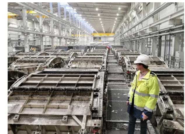
**Hohe Anforderungen – Die Fehlertoleranz bei der Produktion der riesigen Betonteile liegt im Millimeterbereich.**
