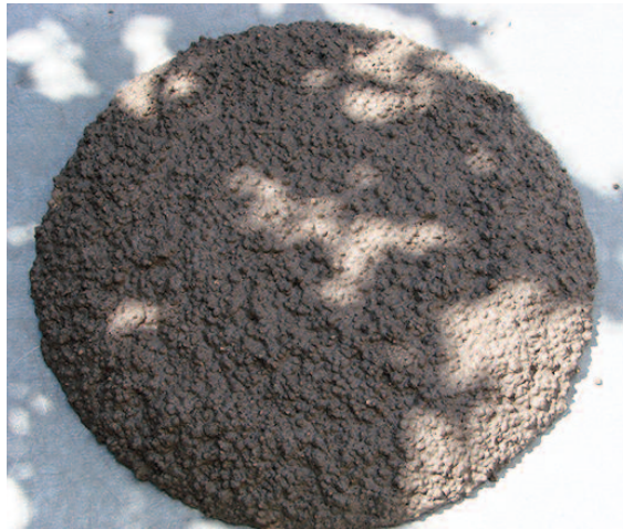
Mit Polystyrolhartschaum ergibt sich die Konsistenz F4 für Ausgleichsschichten im Gefälle
