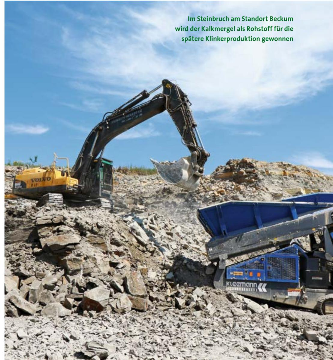
Im Steinbruch am Standort Beckum wird der Kalkmergel als Rohstoff für die spätere Klinkerproduktion gewonnen
